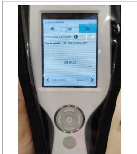
Imagen 14. Resultado de luminómetro superficie correspondiente a mesón línea de pulpa, la cual arrojó 29 URL (aprobado).
