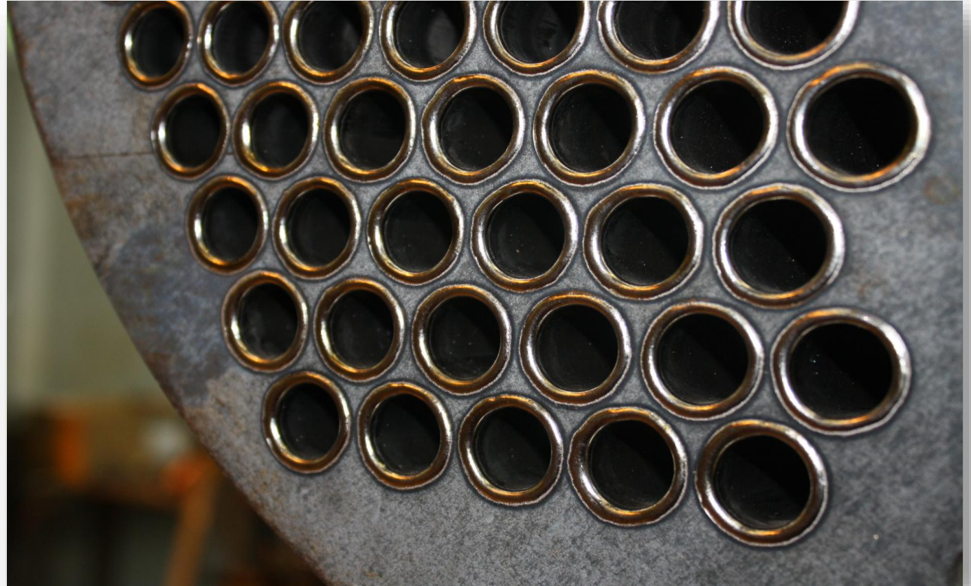
Placa de Titanio / los tubos se unen por medio de una expansión y soldados para prevenir filtraciones.
